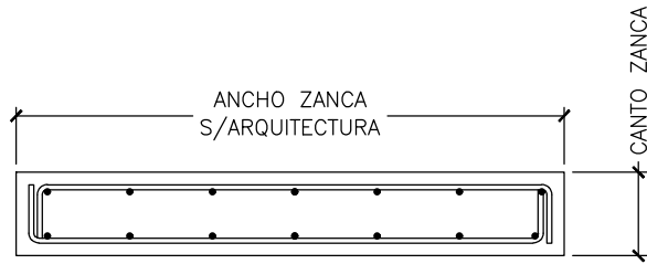
SECCIÓN TRANSVERSAL TIPO DE ZANCA DE ESCALERA ESCALA 1:20 (NOTA: TODAS LAS COTAS ESTAN EN METROS)
